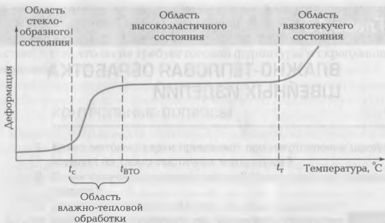
Рис. 15.1. Термодинамическая кривая монолитного полимера:
