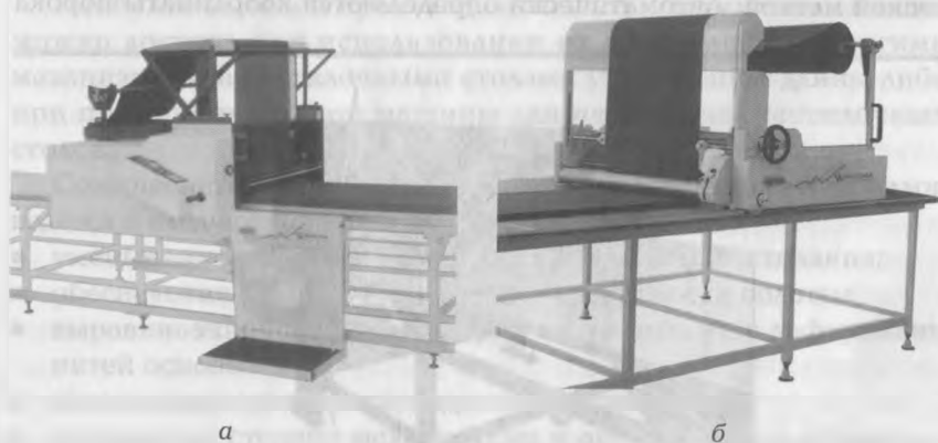
Рис. 2.16. Настилочные машины TexSpread 7100 (Германия) для настиления трикотажа:
