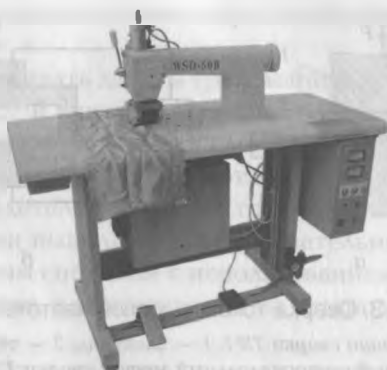
Рис. 14.2. Обработка ленты на ультразвуковой машине WSD-50B
