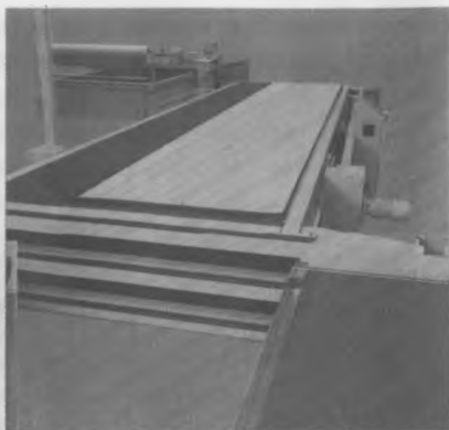
Рис. 2.13. Многоплоскостной настильно-раскройный стол-накопитель трехэтажный TexTrans (Германия)
