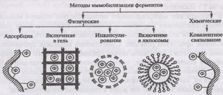
Рисунок 70 – Методы иммобилизации ферментов (Ф-молекула фермента)
