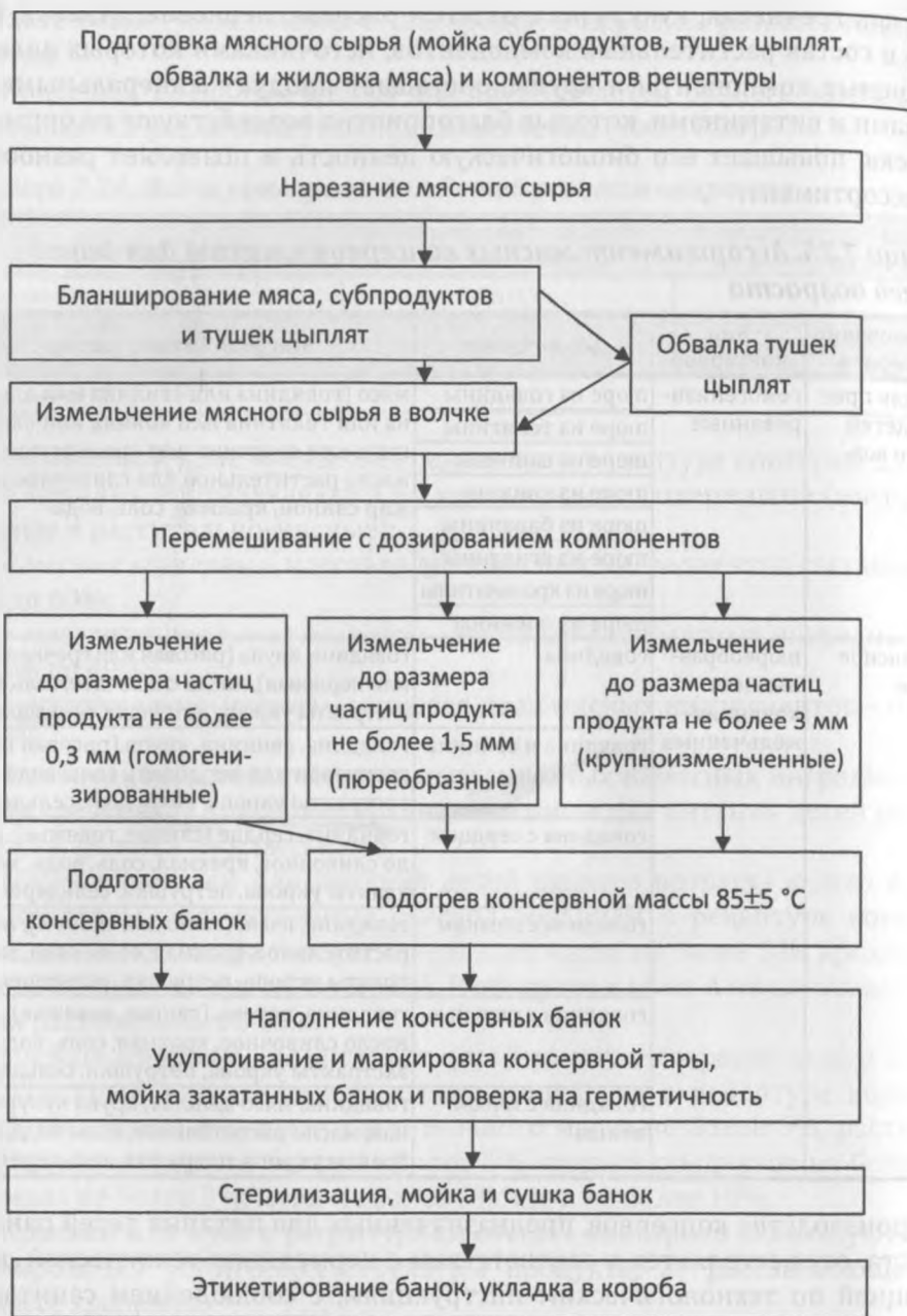
Рис. 7.11. Технологическая схема производства консервов на оборудовании периодического действия
