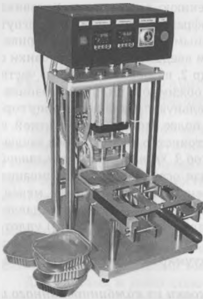
Рис. 6.29. Автомат для герметизации консервов в банках из комбинированного материала (ламистер)
