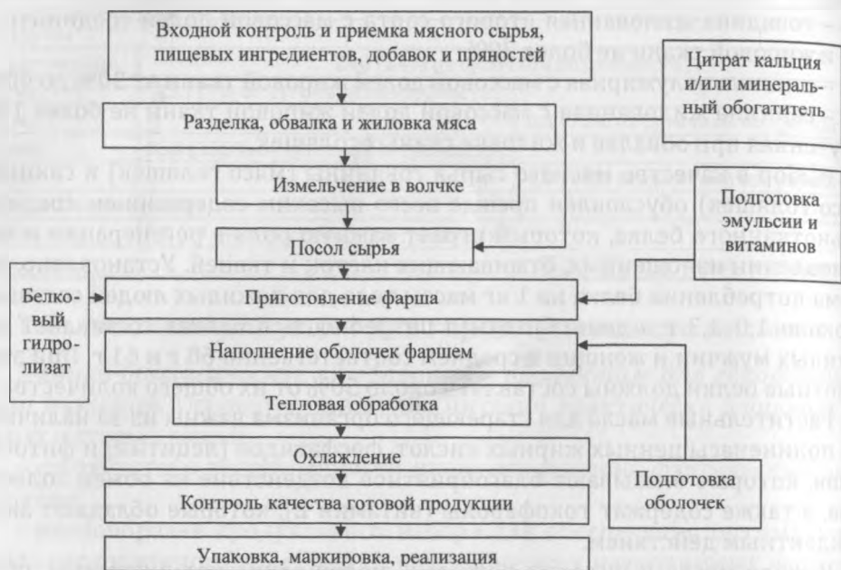
Рис. 7.6. Технологическая схема производства вареных колбасных изделий для геродиетического питания
