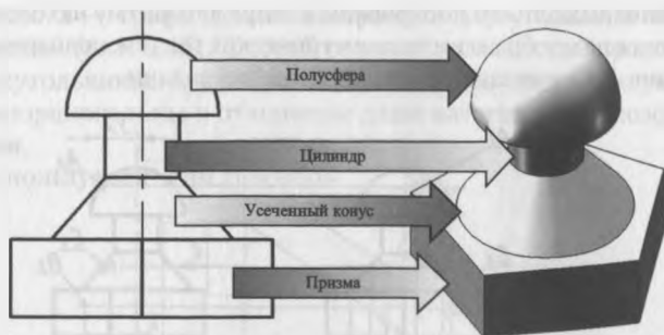
Рис. 2.11. К примеру 2.4. Анализ формы детали
