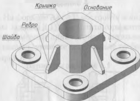
Рис. 4.38. К варианту 1 задания 4.2. Сварная сборочная единица «Крышка»
