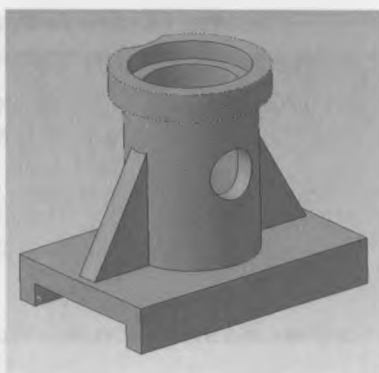
Рис. 6.23. Трехмерная модель детали с ребрами жесткости, созданная в КОМПАС-3D
