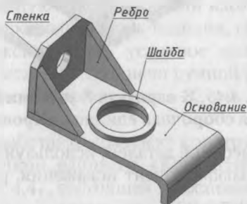
Рис. 4.44. К варианту 7 задания 4.2. Сварная сборочная единица «Уголок»
