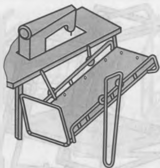
Рис. 5.12. Внутрипроцессные транспортные плоскости для хранения и передачи пачек деталей и полуфабрикатов
