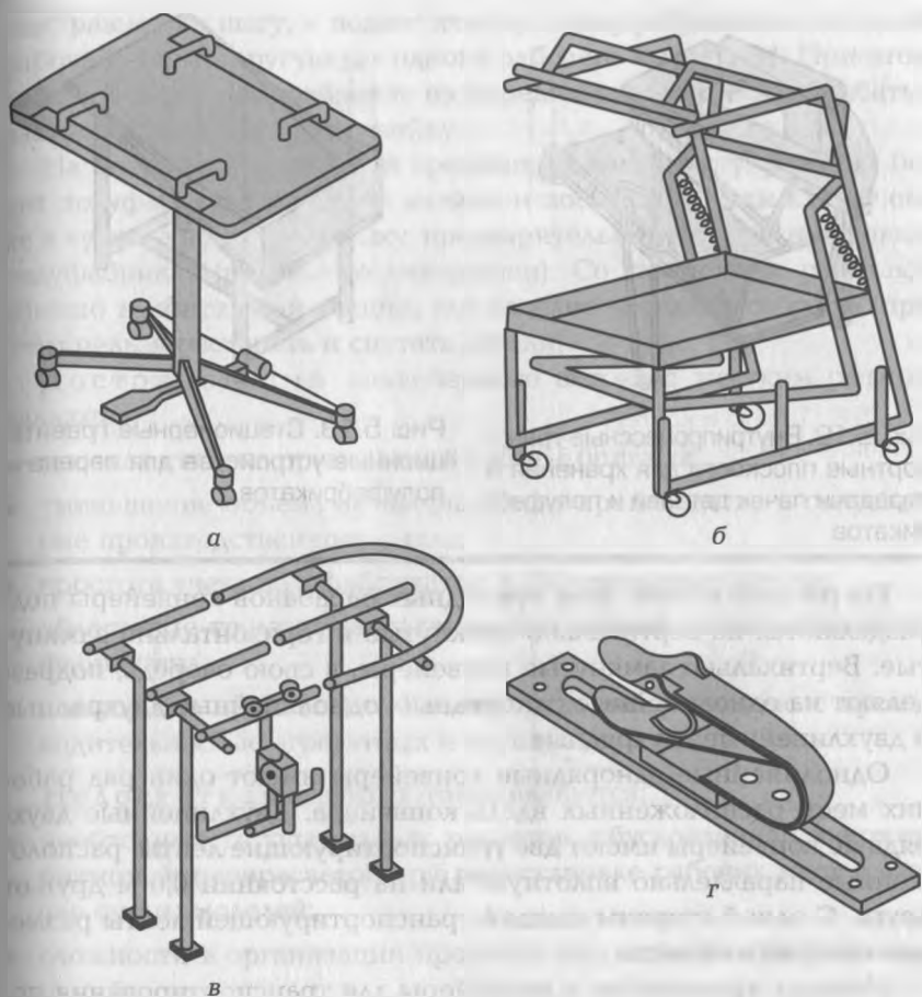
Рис. 5.11. Устройства фиксации и транспортирования пачек деталей и полуфабрикатов:
