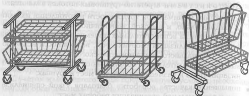
Рис. 5.8. Тележки-контейнеры напольного транспортирования для перемещения и хранения пачек кроя, деталей и полуфабрикатов
