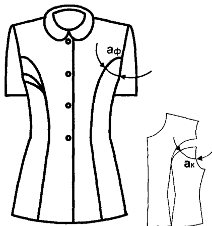
Рис. 24. Схема к определению углов \alpha_\phi и \alpha_k на ГМО и в конструкции для определения показателя качества K_{51122}
