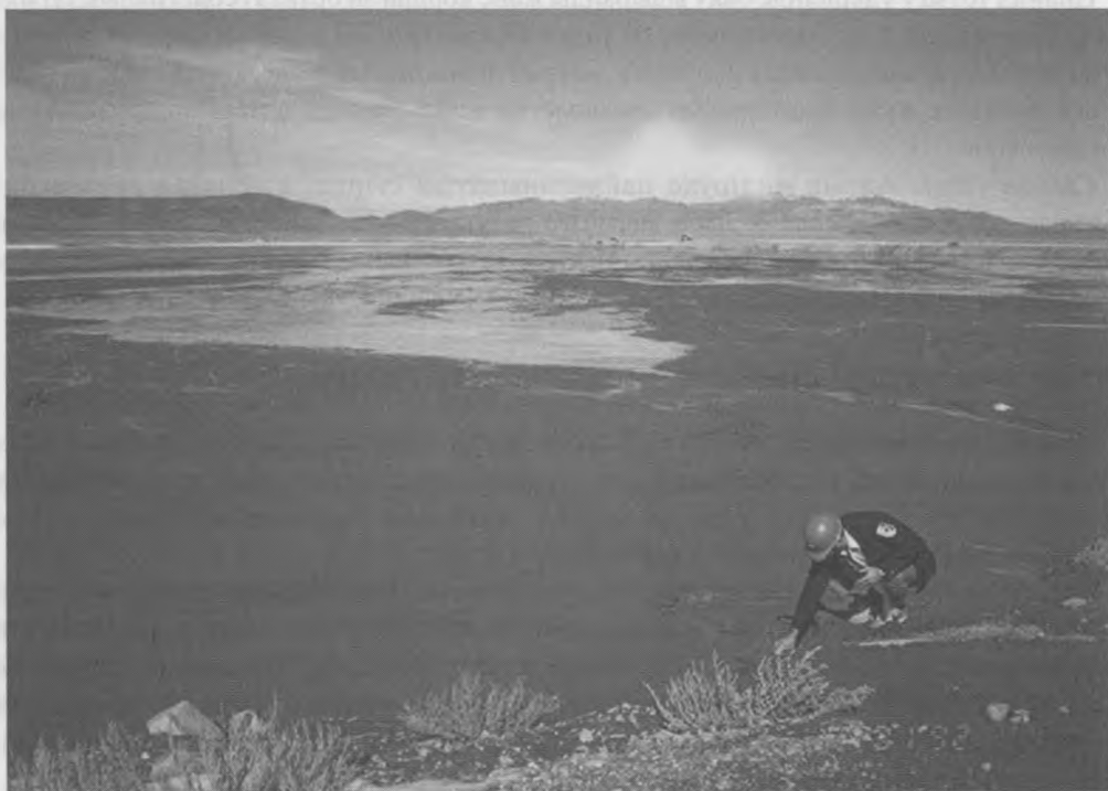
16.3-СУРЕТ. Невада штаты, Элко маңында алтын өндіру барысындағы шоғырдан шығарылған цианидті қалдықтарды жинайтын «қалдық қойма» (АҚШ жабайы аңдар мен балық шаруашылығын қорғау Қызметі ұсынған).
