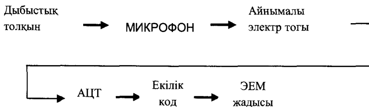
2.8-сурет. Дыбыстық толқындардың екілік кодқа айналу үрдісі
