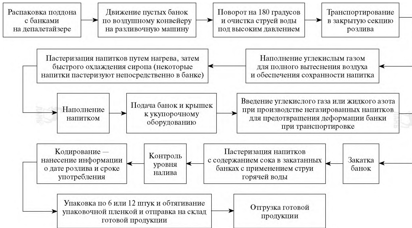
Рис. 59. Схема розлива безалкогольных напитков в алюминиевые банки
