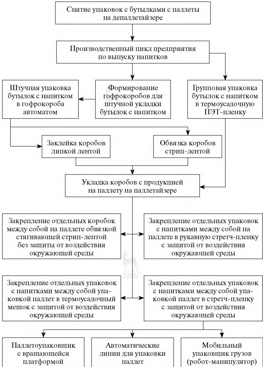
Рис. 76. Принципиальная схема организации групповой упаковки готовой продукции на предприятии по выпуску безалкогольных напитков
