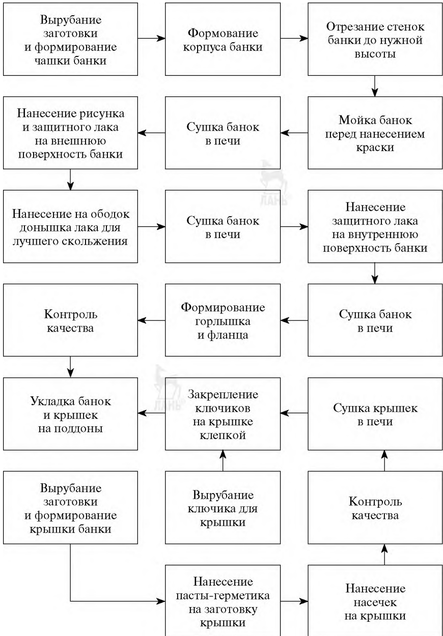
Рис. 51. Технологическая схема производства алюминиевых банок
